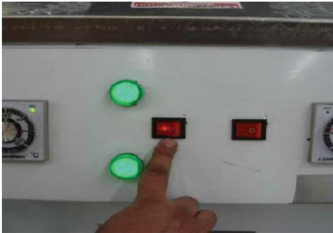
**4** Encender switch de control de temperatura.
