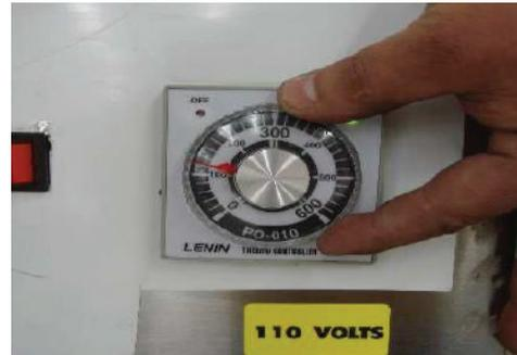
**5** Girar pirómetro de placa inferior a 140°C, se encenderá foco piloto y se apagará al llegar a la temperatura asignada.
