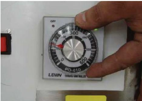
**6** Girar pirómetro de placa superior a 120°C, se encenderá foco piloto y se apagará al llegar a la temperatura asignada.
